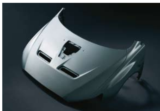
Funkční otvory pro proudění vzduchu v hliníkové kapotě
