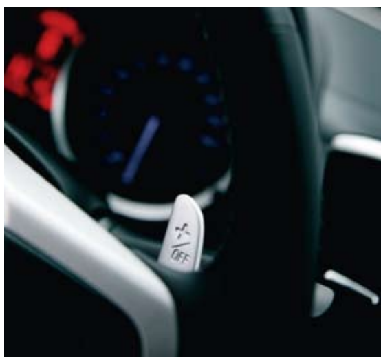
Řadicí páky z hořčíkové slitiny umístěné pod volantem
