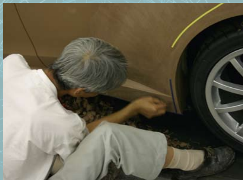
Vytvarování vystouplého blatníku patřilo k největším překážkám, které bylo nutné překonat
